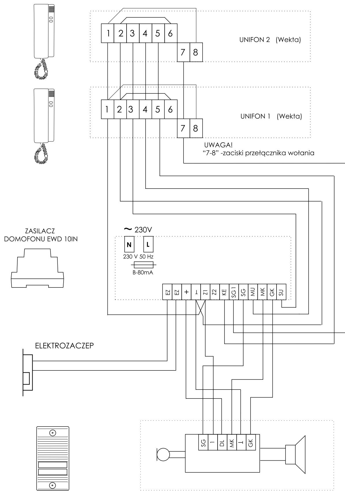
Schemat połączeń zestawu domofonowego interkomowego Mi2
