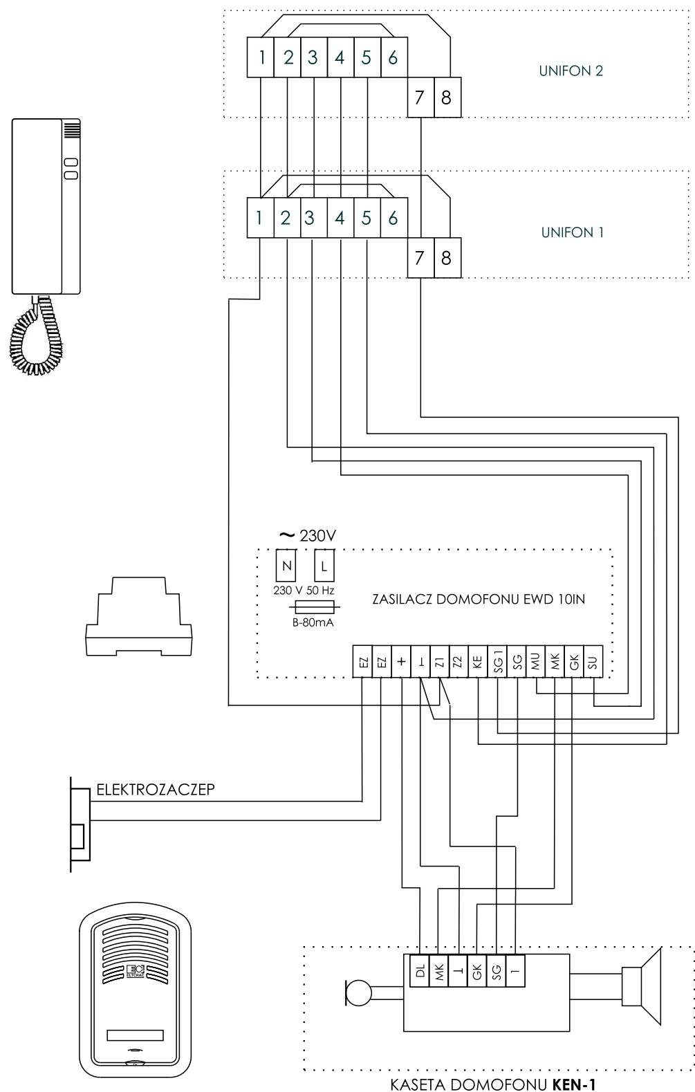
Schemat połączeń zestawu domofonowego interkomowego Zi2
