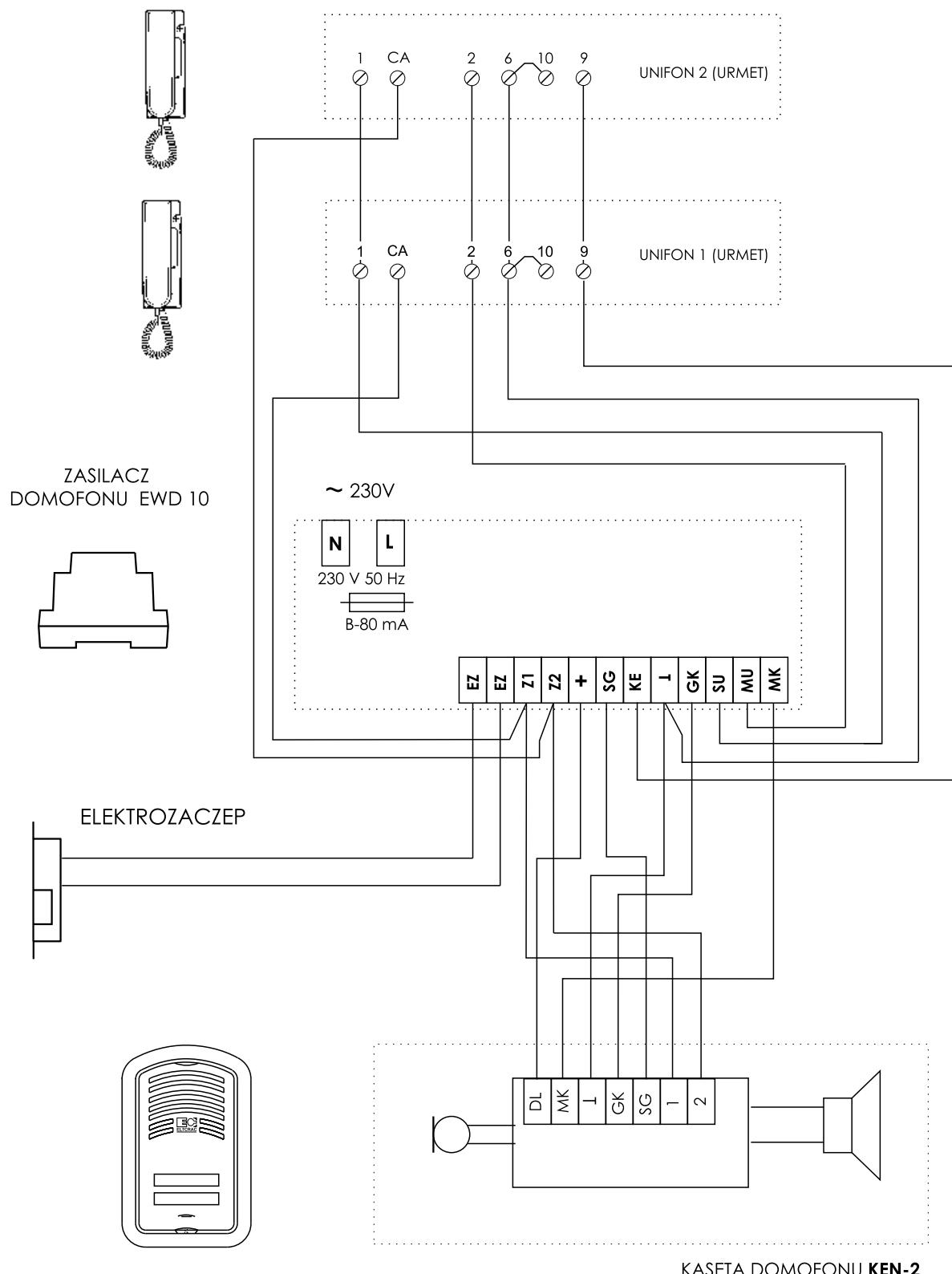
Schemat połączeń zestawu domofonowego Z-2
