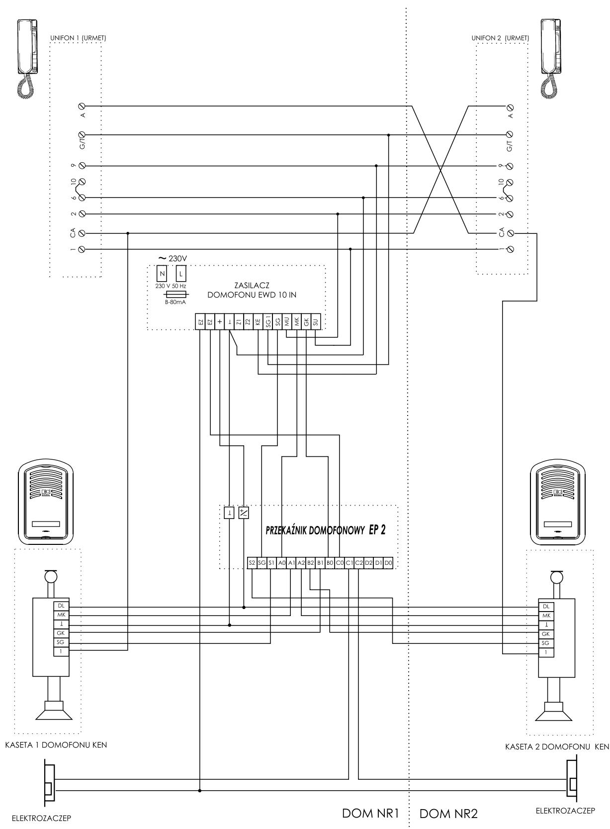
Schemat połączeń przekaźnika EP2 do zestawu domofonowego interkomowego 2-numerowego z kasetami KEN2 i unifonami 1131/1, 1132/1, 1133/1
