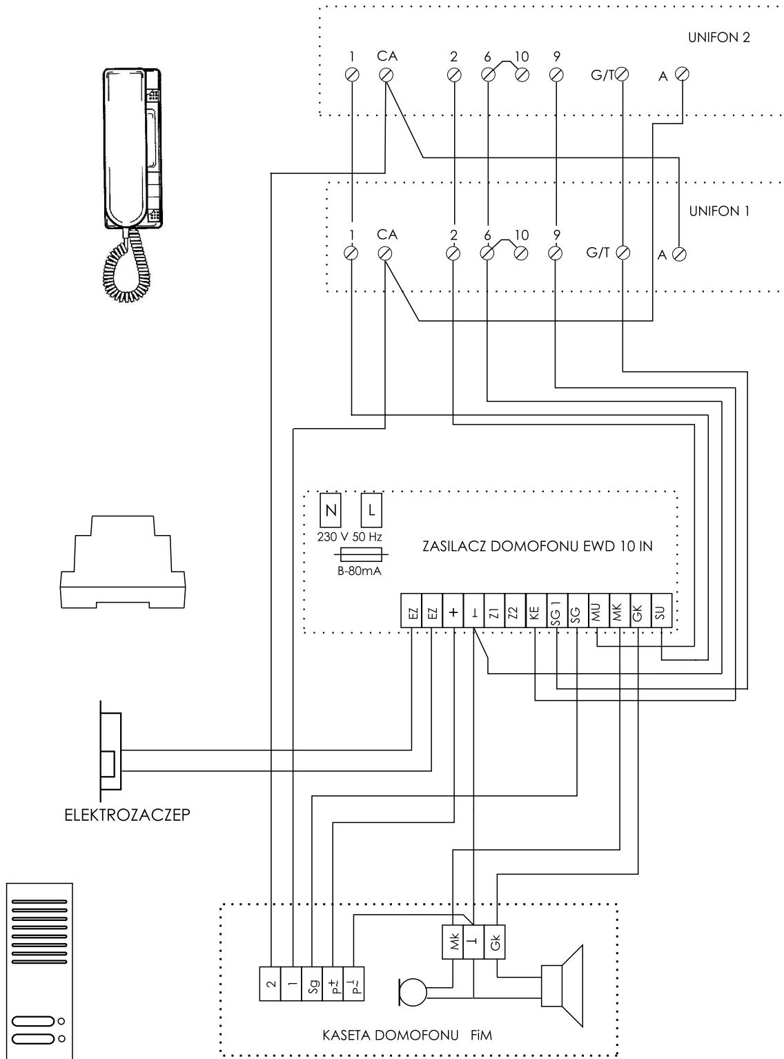
Schemat połączeń zestawu domofonowego interkomowego
