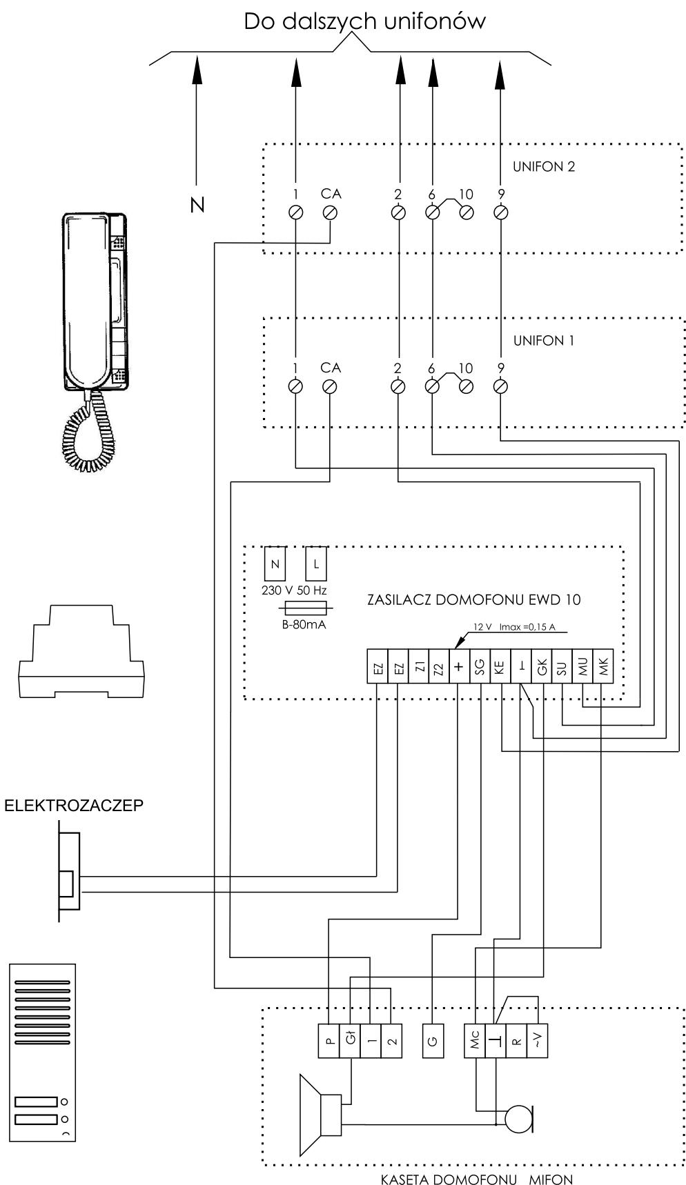
Schemat połączeń zestawu domofonowego interkomowego
