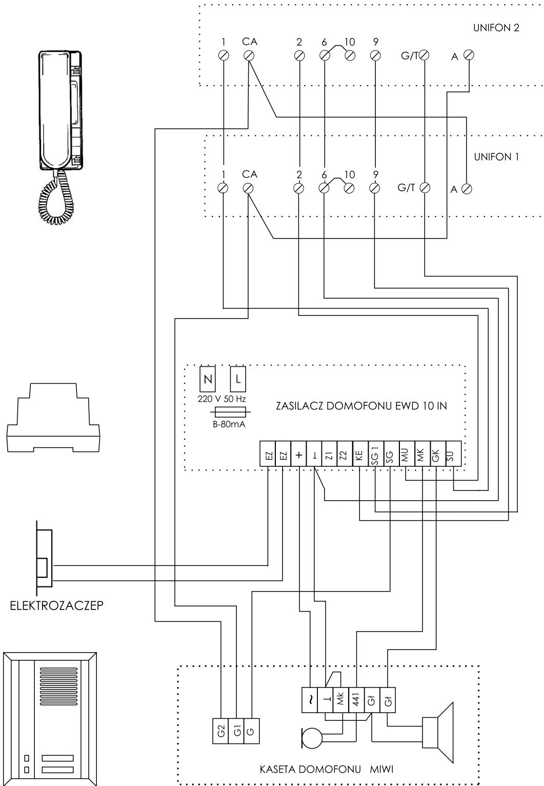
Schemat połączeń zestawu domofonowego interkomowego
