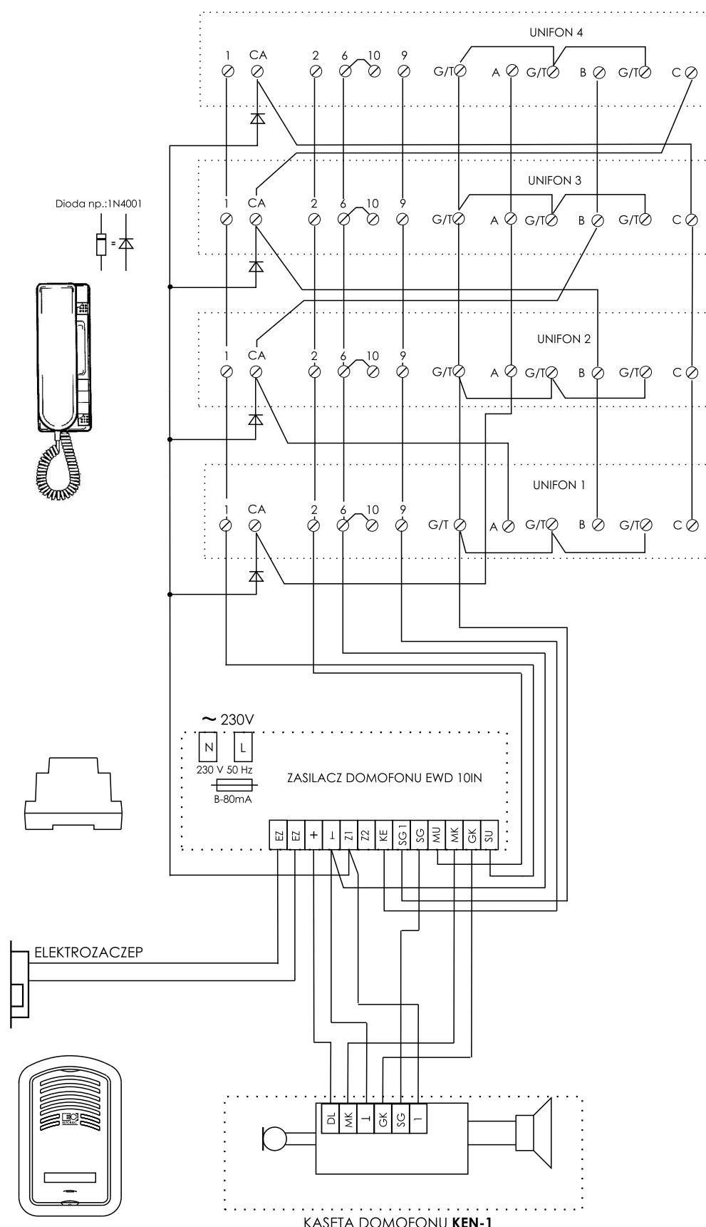
Schemat połączeń zestawu domofonowego interkomowego Zi1
