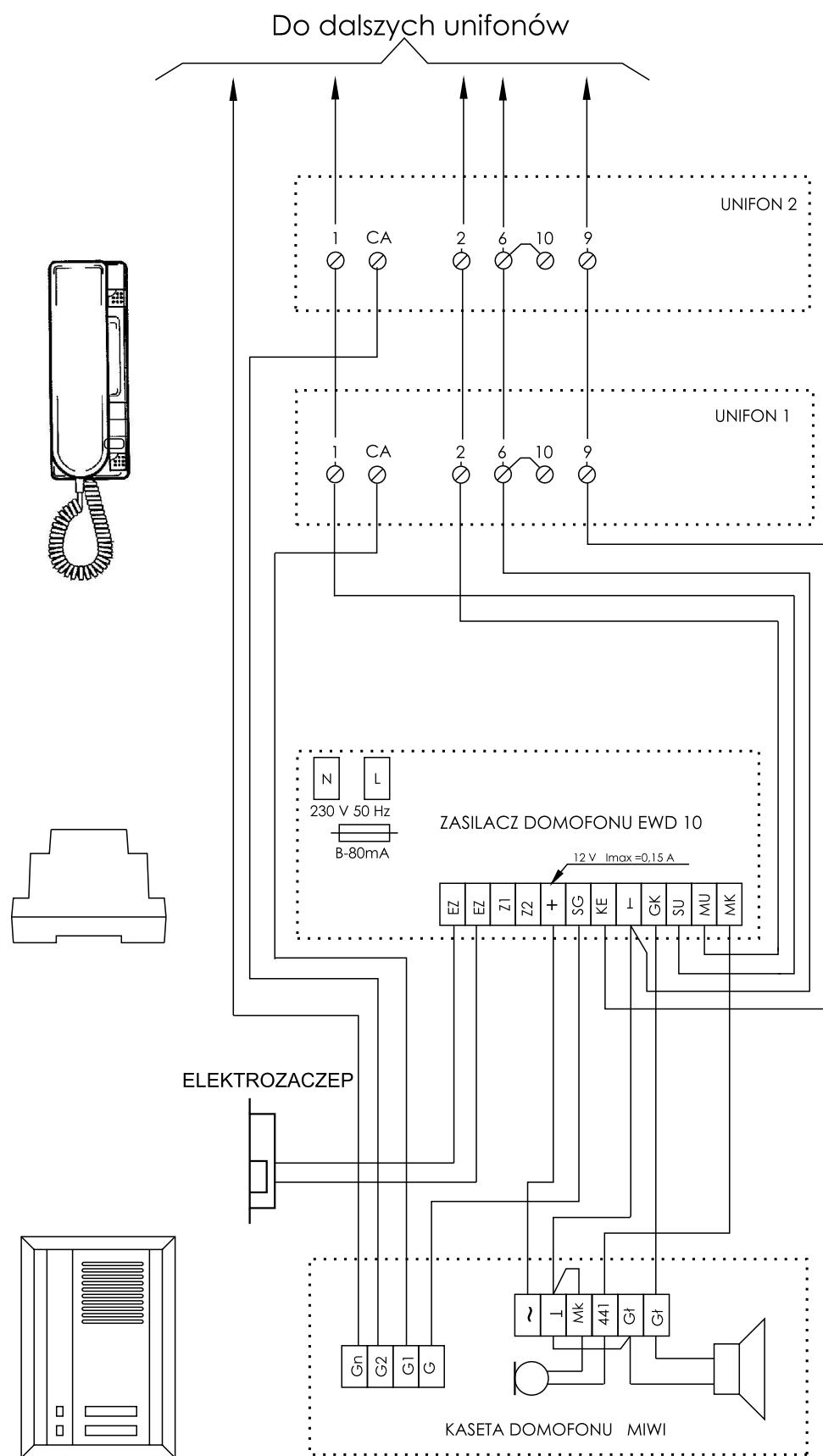
Schemat połączeń zestawu domofonowego z kasetą MIWI
