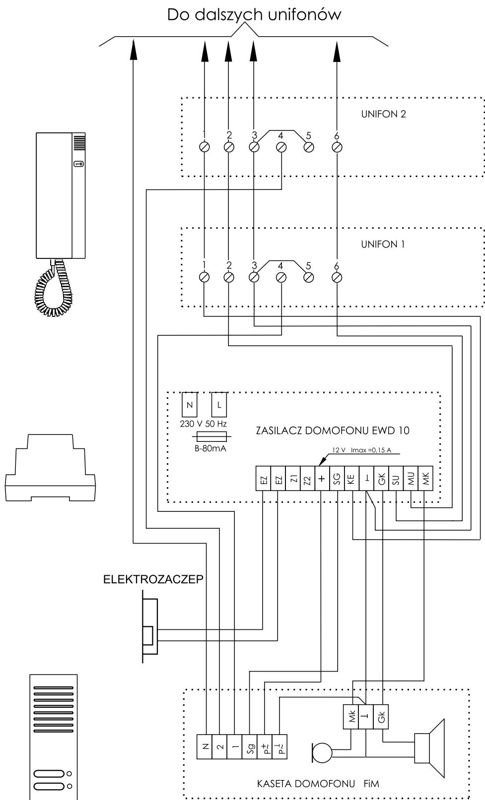
Schemat połączeń zestawu domofonowego 2-numerowego
