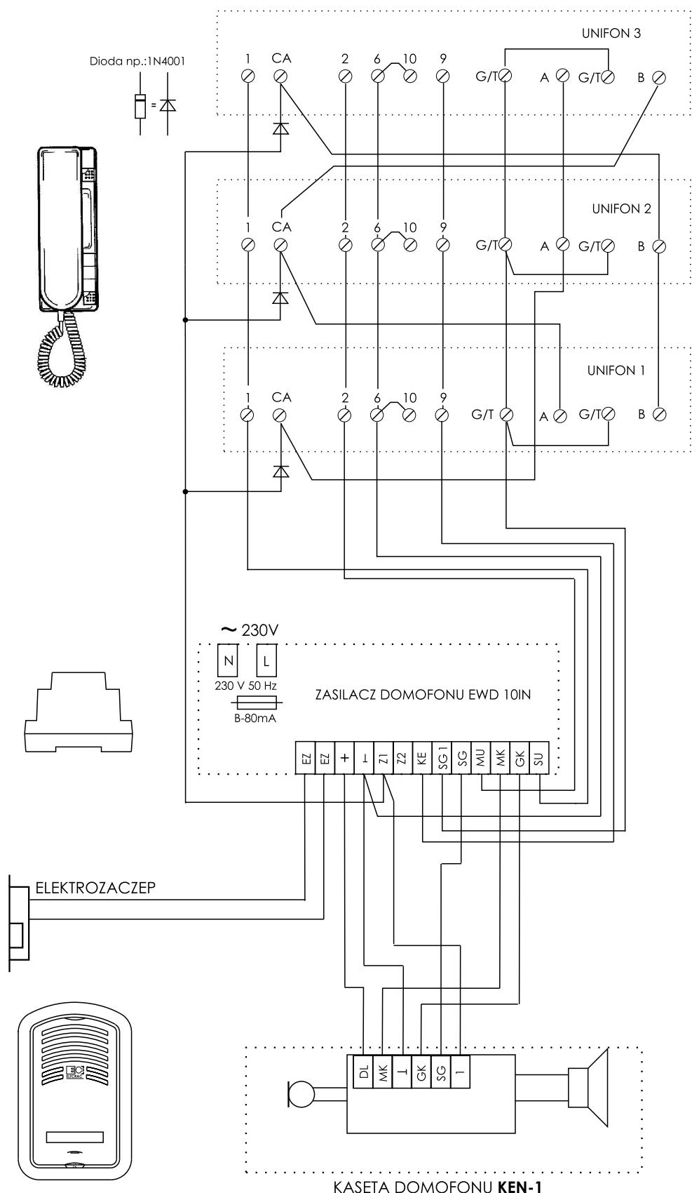
Schemat połączeń zestawu domofonowego interkomowego Zi1
