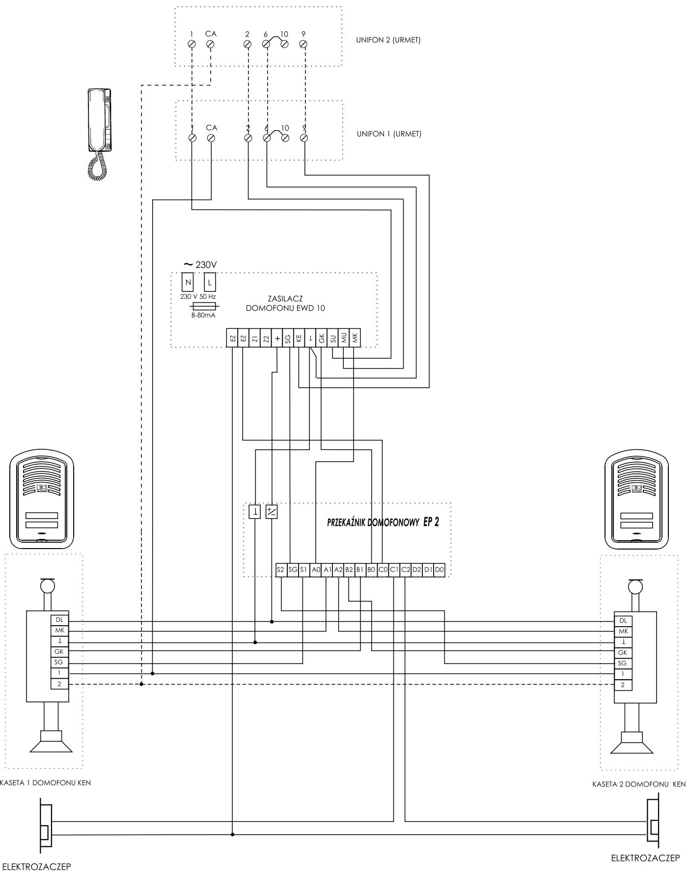
Schemat połączeń przekaźnika EP2 do zestawu domofonowego interkomowego z 2 kasetami KEN1 oraz unifonami 1131/1, 1132/1, 1133/1
