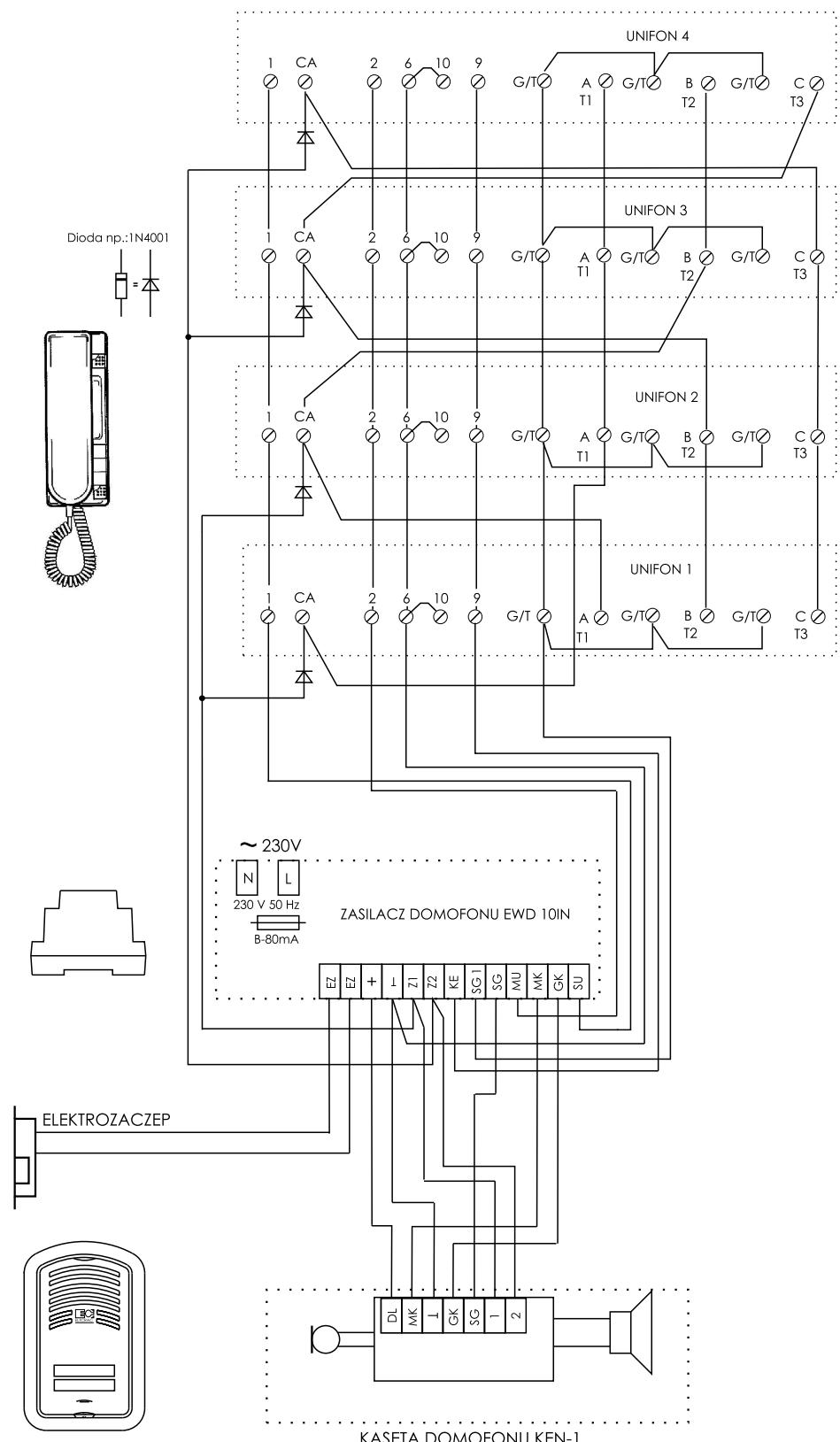
Schemat połączeń zestawu domofonowego interkomowego Zi2
