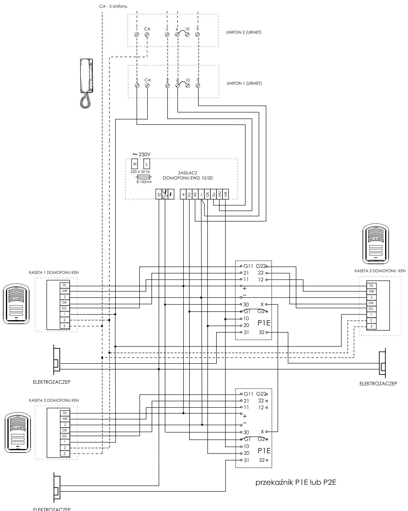
Schemat połączeń zestawu domofonowego z kasetą KE,
