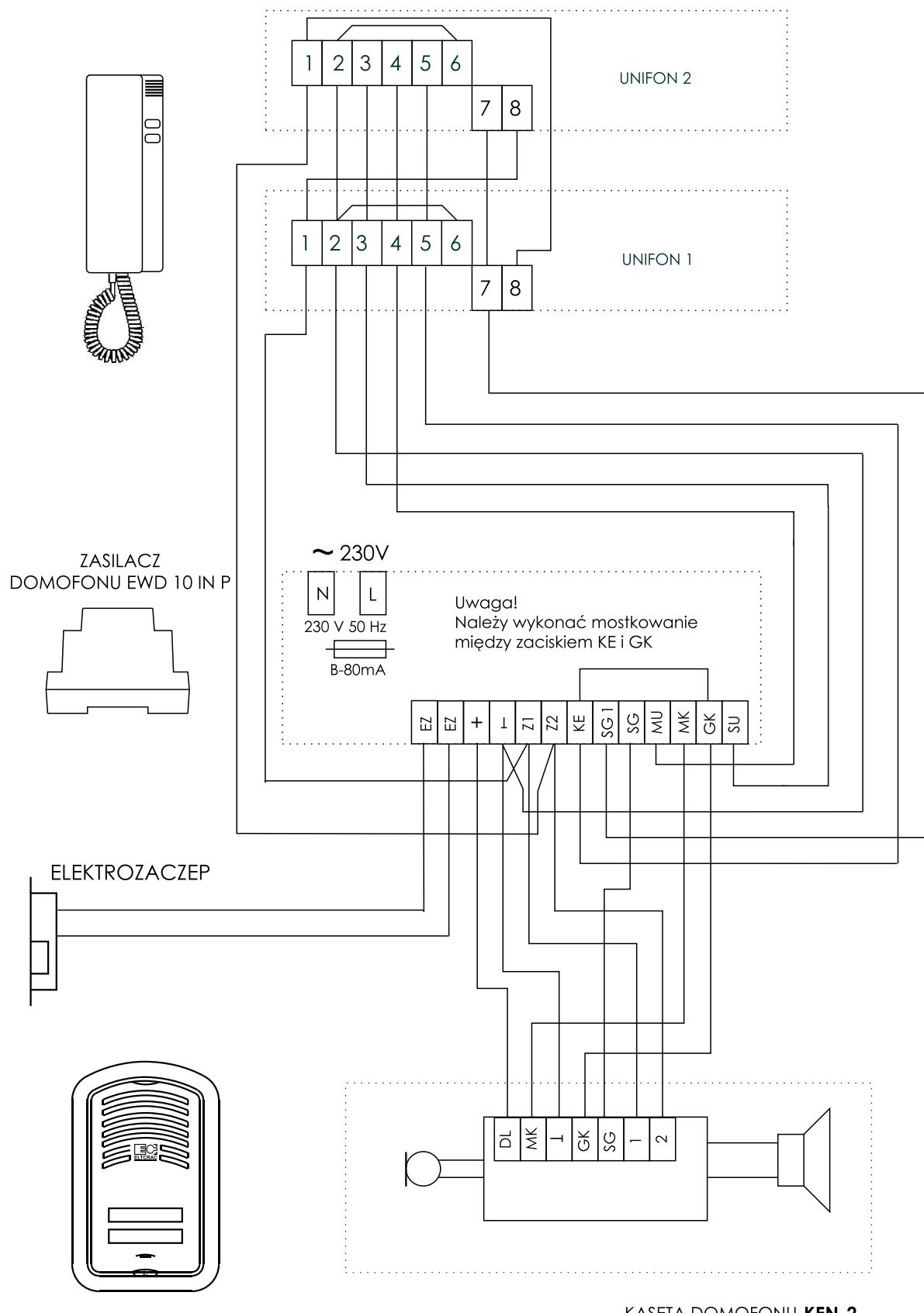
Schemat połączeń zestawu domofonowego M1
