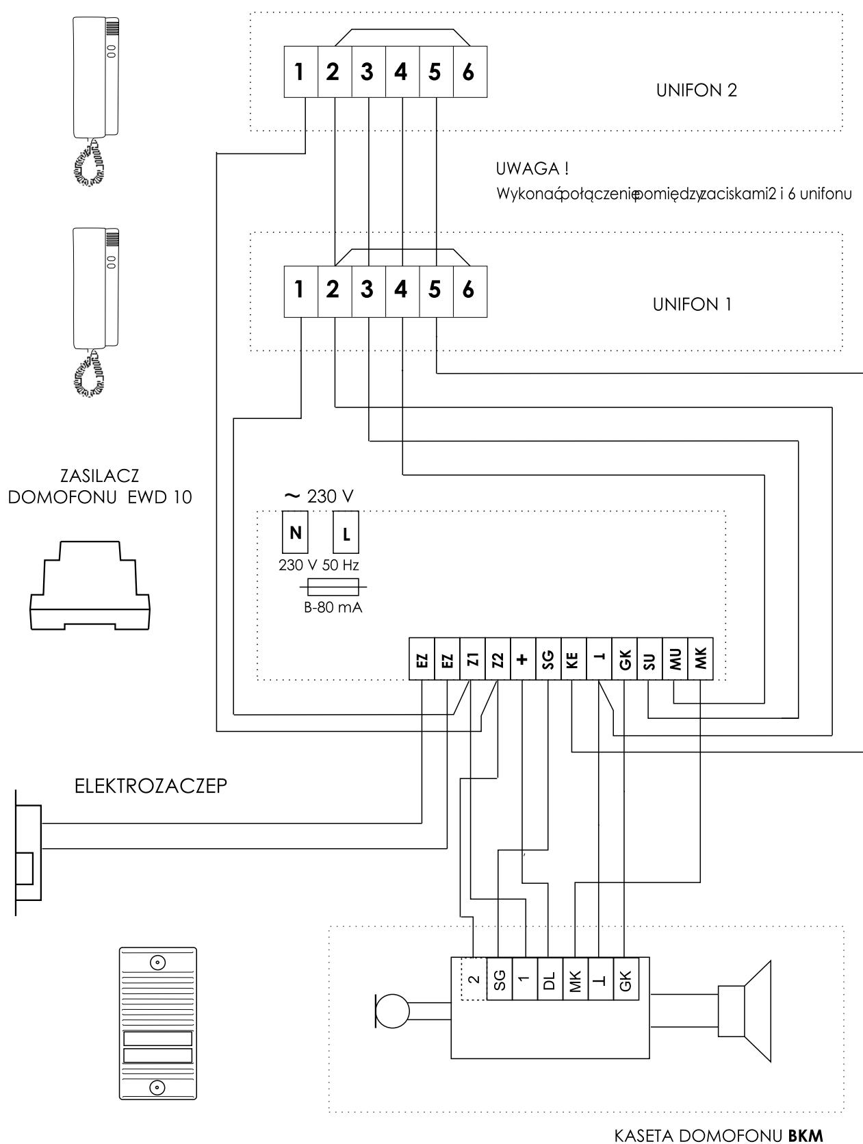
Schemat połączeń zestawu domofonowego interkomowego Mi1
