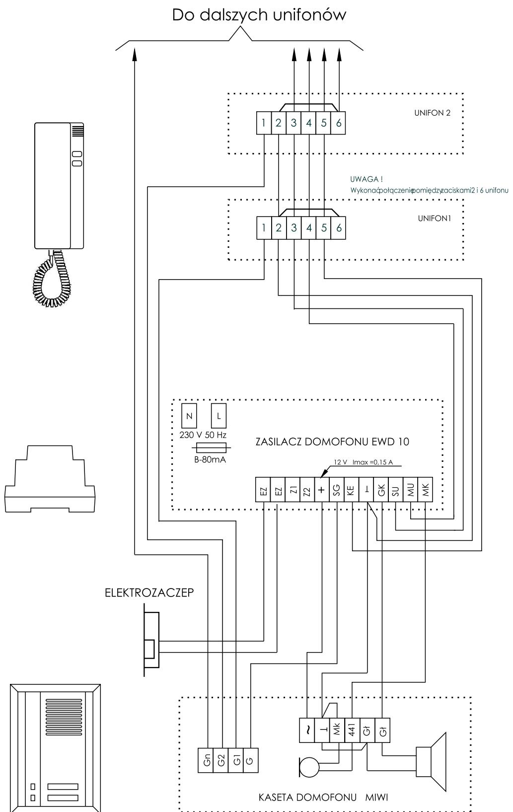
Schemat połączeń zestawu domofonowego z kasetą MIWI
