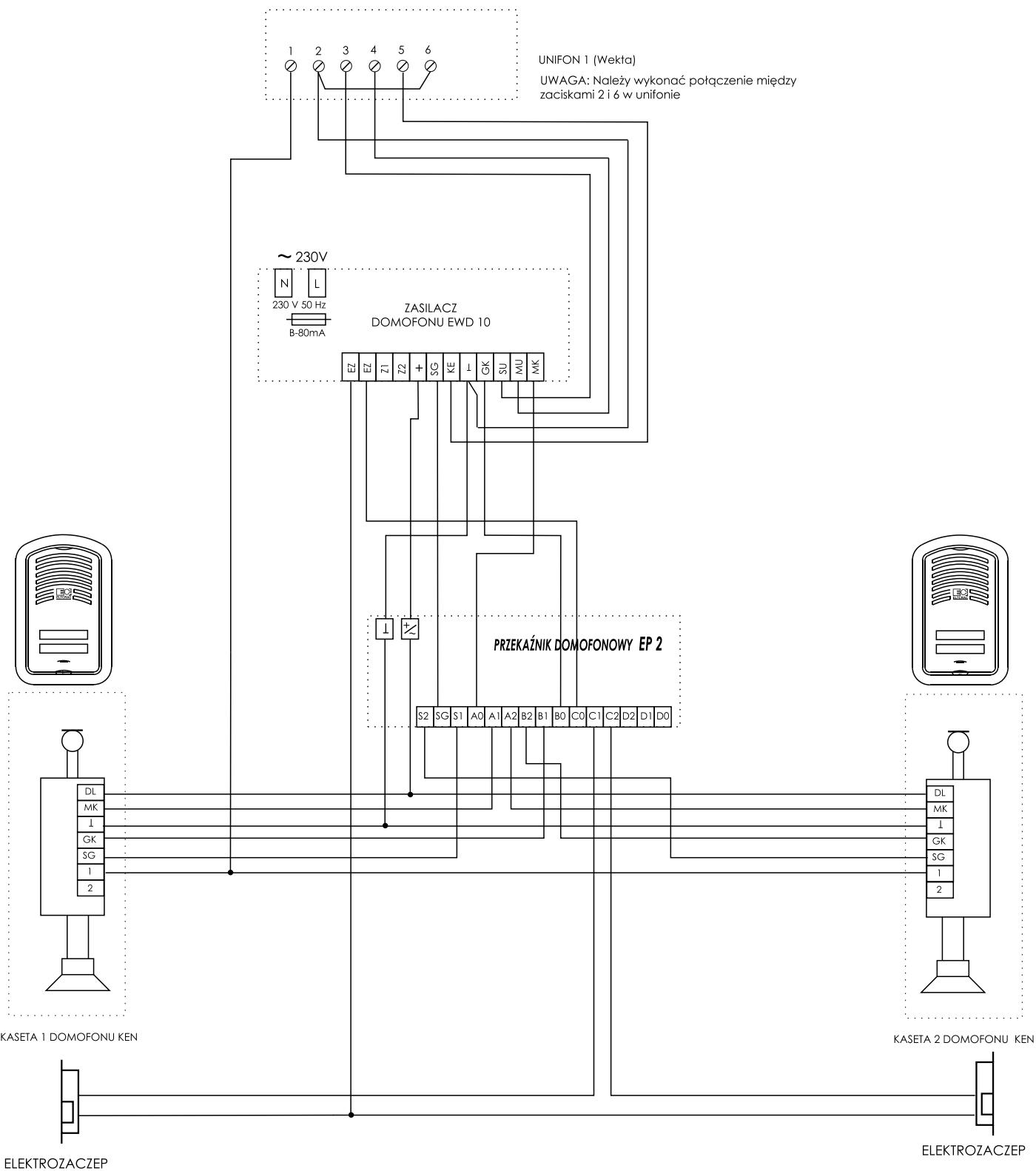
Schemat połączeń przekaźnika EP2 do zestawu domofonowego z 2 kasetami KEN i unifonami 1131, 1132, 1133
