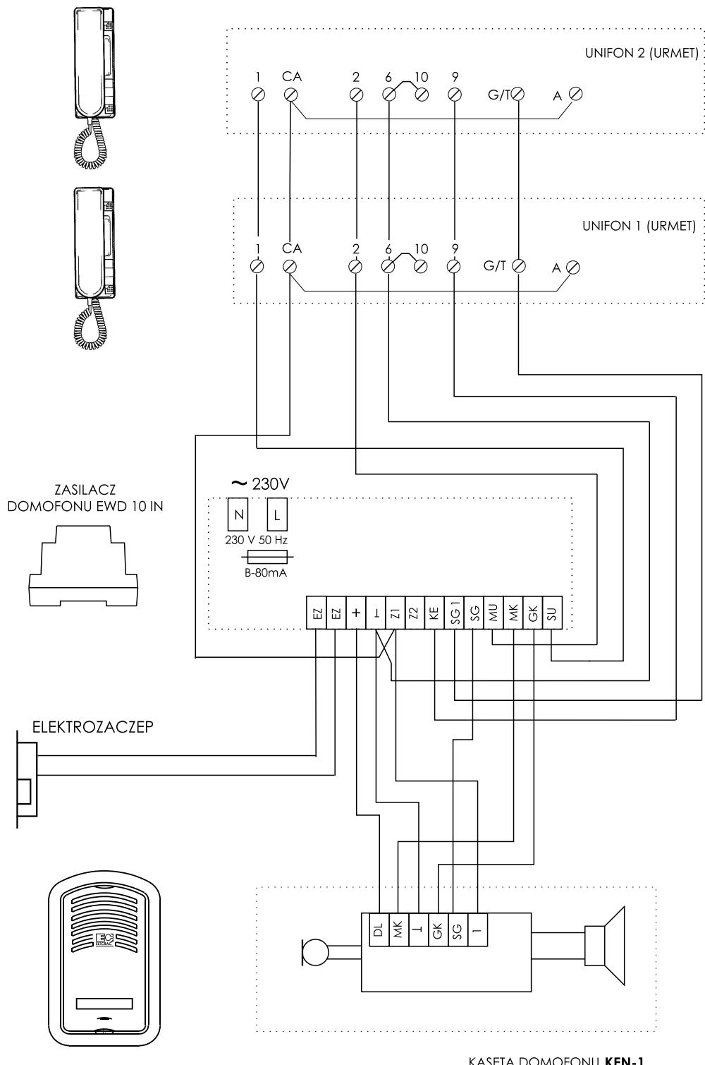
Schemat połączeń zestawu domofonowego interkomowego Zi1
