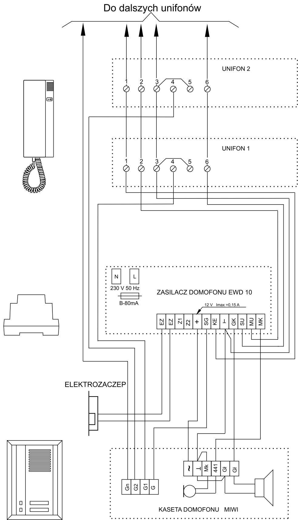
Schemat połączeń zestawu domofonowego interkomowego 2-numerowego z kasetą MIWI oraz unifonami 1131, 1132, 1133
