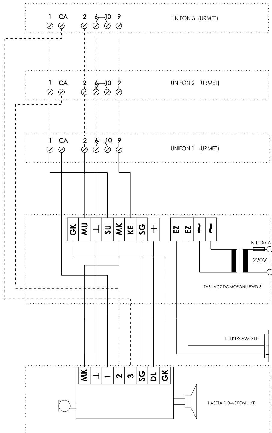
Schemat połączeń zestawu domofonowego z kasetą MIWI
