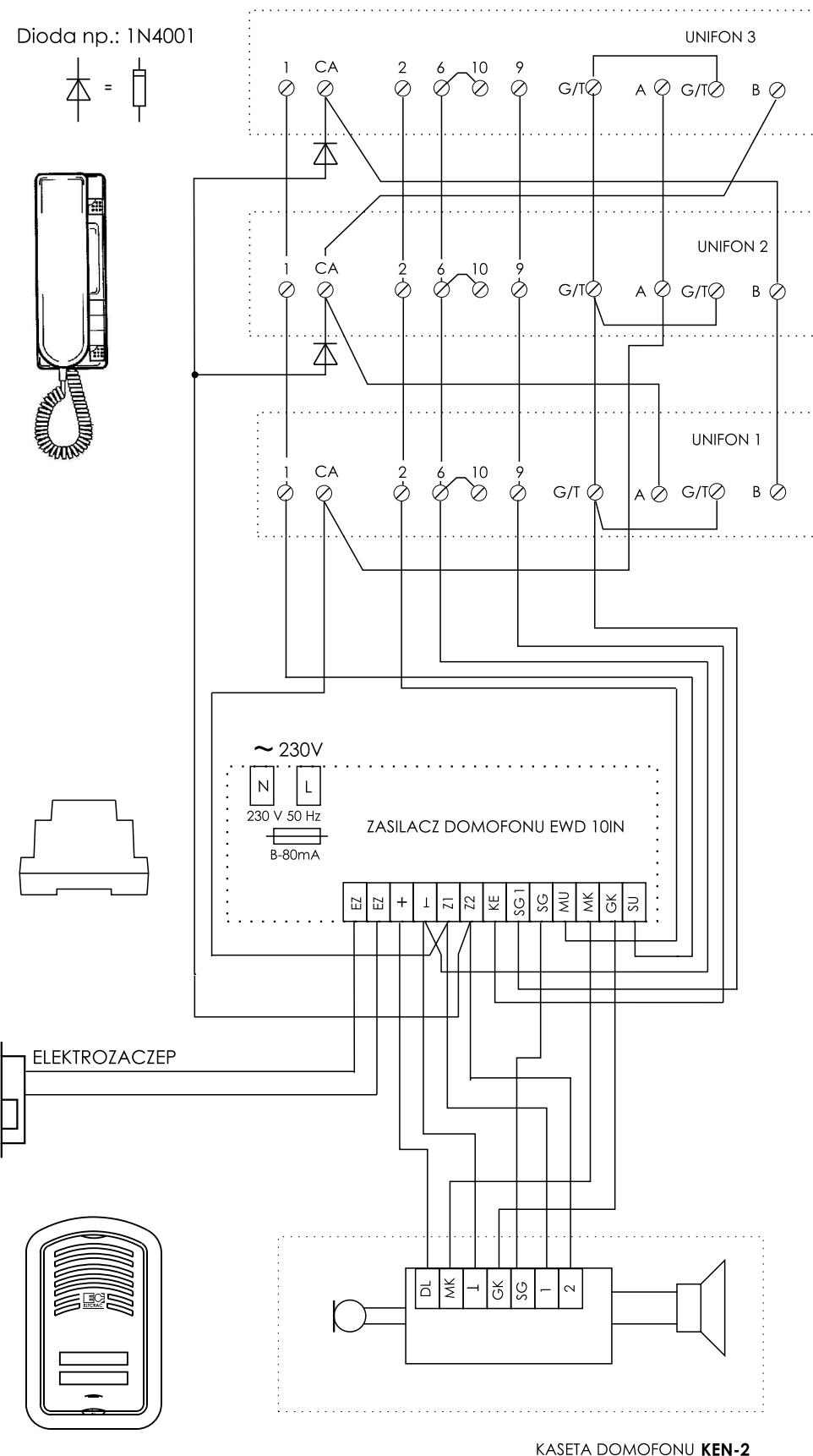
Schemat połączeń zestawu domofonowego interkomowego Zi2
