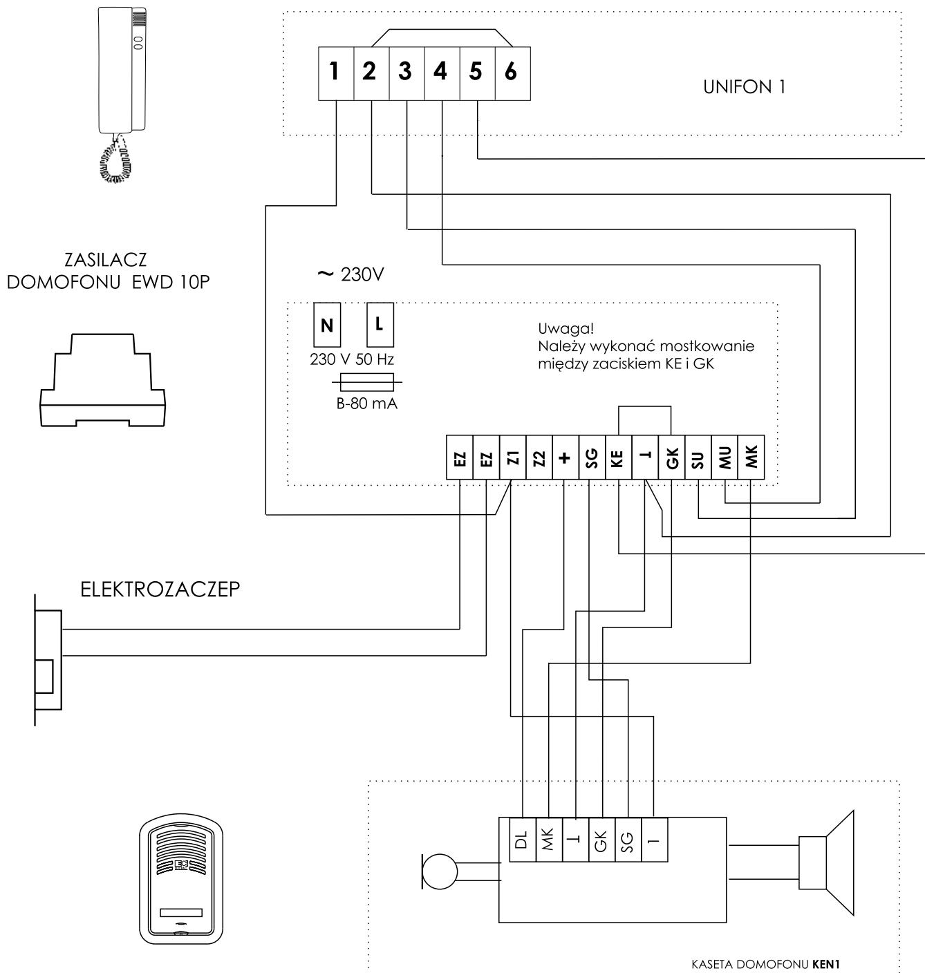
Schemat połączeń zestawu domofonowego Z-2
