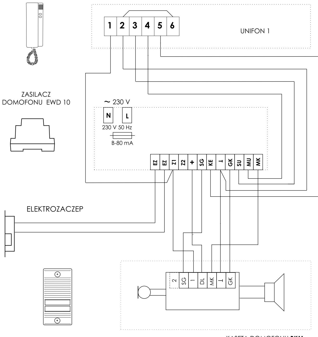
Schemat połączeń zestawu domofonowego M2
